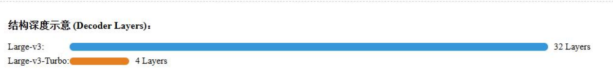
图 5-2 Whisper Large-v3 与 Whisper Large-v3-Turbo 结构参数对比
